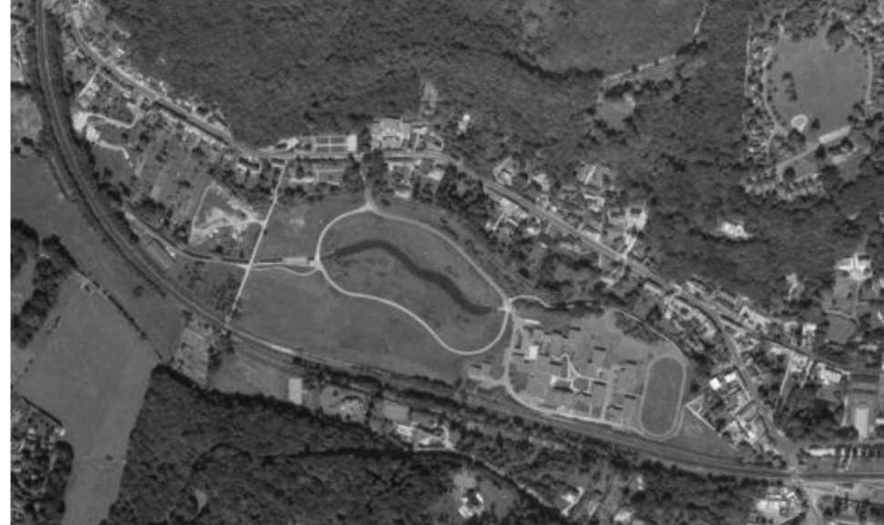
1987 : le bassin terminé tel qu'actuellement avec la présence du décanteur en amont
